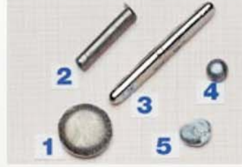
(1,2) TiAl, TiZrCu(3), VMo(4) ve Al 2 O 3 (5) örnekleri Bühler Ark eritme sisteminde hazırlanmıştır.
