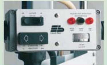
İşlem paneli Fonksiyonlar: akım ON/OFF, Akım ayarı, Elektrot aşağı/yukarı
